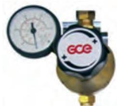
El regulador Unicontrol 700 es un regulador línea de baja presión con capacidad media de gran fiabilidad gracias a su válvula de regulación encapsulada. Se usa como segunda etapa de regulación con gases comprimidos o como regulador principal para fuentes de gas en fase líquida se suministra solo o ya integrado como punto de uso, con soporte válvula y filtro (ver UNISET, página 197).
