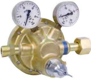
Reguladores VPK 251 y VPKU 91 son reguladores de simple etapa pilotados de alta presión y gran caudal. La regulación de la presión de servicio se hace mediante un regulador, integrado en el cuerpo del regulador, lo que permite a estas presiones y caudales, tener un regulador industrial duradero, robusto y bastante compacto. (peso:9.4 kg).
