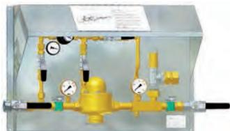
El Panel de regulación TDS esta compuesto de un regulador de Dome pilotado por un regulador Unicontrol. Está provisto de válvula de seguridad y válvulas de cierre a la entrada y la salida. Esta montado sobre un soporte de acero singado, previsto para protegerlo de la intemperies.
